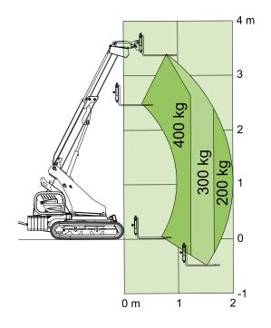
De maximumcapaciteit van de Handler 400 met ingetrokken giek is 400 kg, incl. het gewicht van de vorken.
